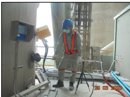
ภาพที่ 3.4 การตรวจวัด SO 2 จากปล่องหม้อเผา
