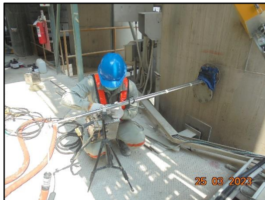
ภาพที่ 3.3 การตรวจวัด NO x as NO 2 จากปล่องหม้อเผา
