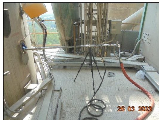
ภาพที่ 3.5 การตรวจวัดไดออกซิน จากปล่องหม้อเผา
