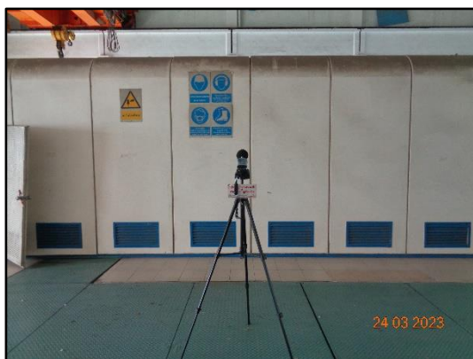
ภาพที่ 3.35 การตรวจวัดระดับเสียงบริเวณเครื่องจักร บริเวณอาคาร Turbine Generator ชั้น 3 ภายในห้องเก็บเสียง (กั้นกันไอน้ำ)
